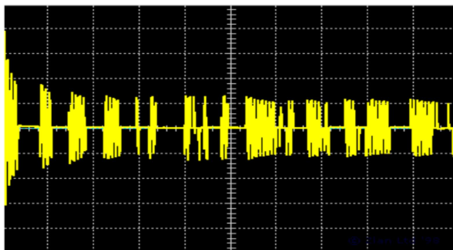
6 , 安装 1KW 灯泡时 , 灯口瞬时虚接产生的波形 :
