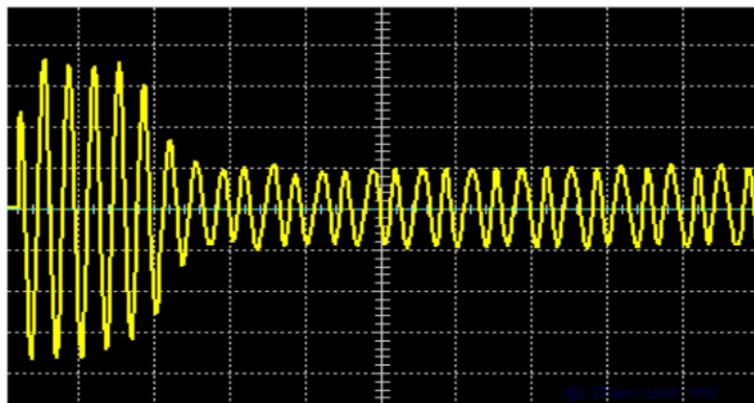
6，安装 1KW 灯泡时，灯口瞬时虚接产生的波形：
