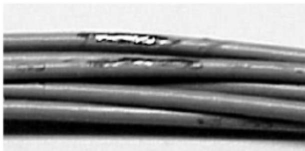
(a) 故障电弧引起的绝缘损坏
